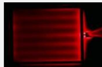
レーザ受光用光電変換素子の順バイアス発光
