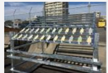
図2 構内での大気曝露試験
