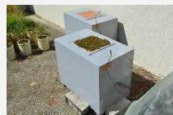
図2 コケ緑化基盤材の温度測定実験
