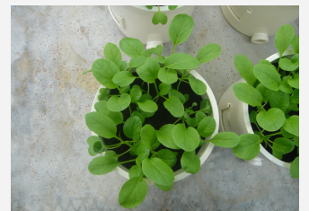
下水汚泥焼却灰を利用した培養土を用いた植物育成実験
